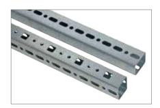
Zesilující prvek vertikálních lišt Přídavný profil zvyšující stabilitu vertikálních lišt (4 ks). Zvýší nosnost rozvaděče až na 1500 kg. U rozvaděče RYA lze použít pouze pro rozvaděč 800 mm široký.
